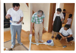
クランプメーター 電流値を測ります
