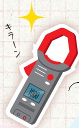
クランプメーター 電流値を測ります
